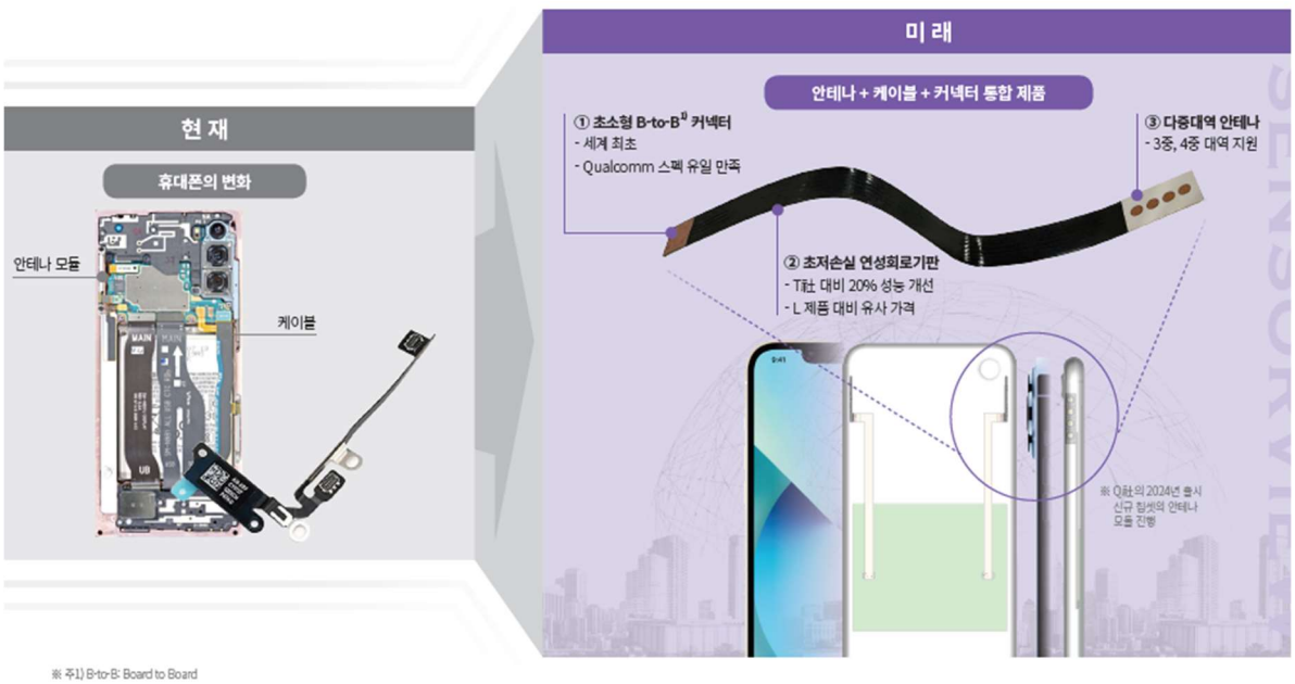
도표 30. 초고주파 최적의 송수신을 위한 디바이스 내 통합 솔루션 (안테나+케이블+커넥터)
