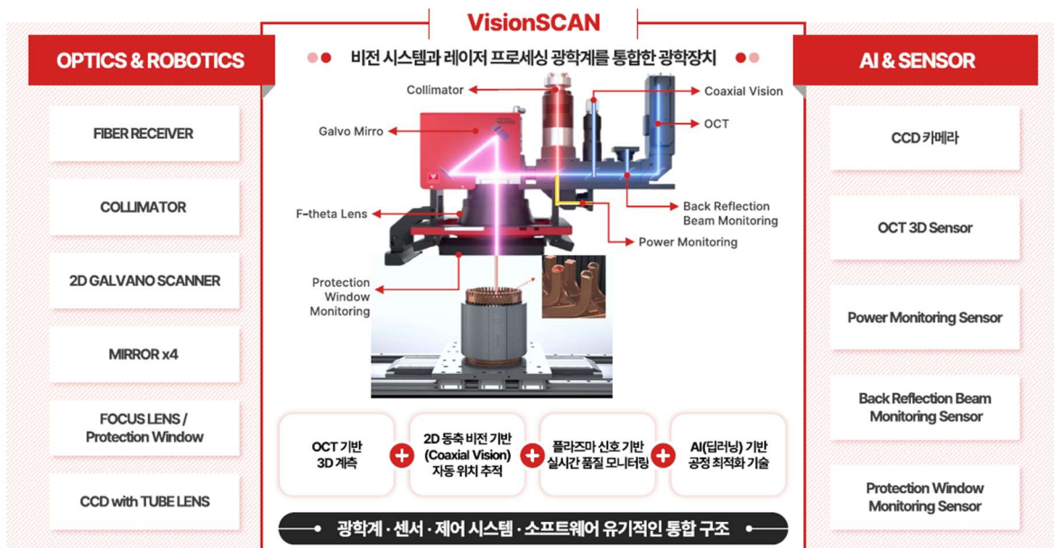
도표 31. 고정밀 · 고속 레이저 프로세싱 제어를 실현하는 VisionSCAN
