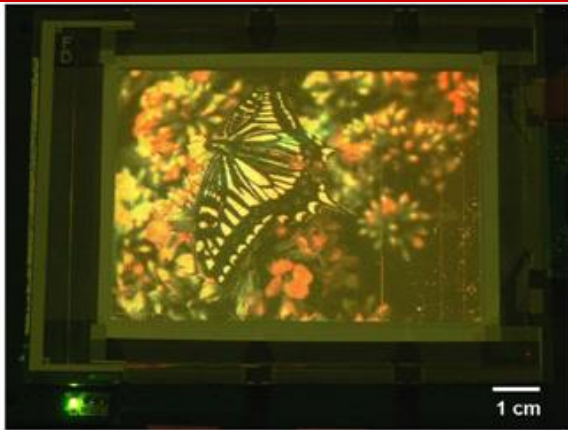
도표 2 유리기판에서 구현한 QD-LED (4인치 QVGA급 풀컬러 디스플레이)
