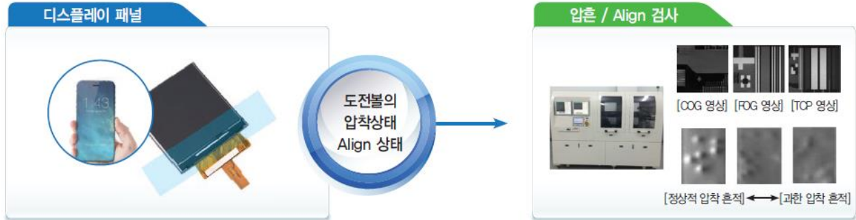
도표 9 머신비전 시스템을 통한 패널의 본딩의 접착 상태 검사
