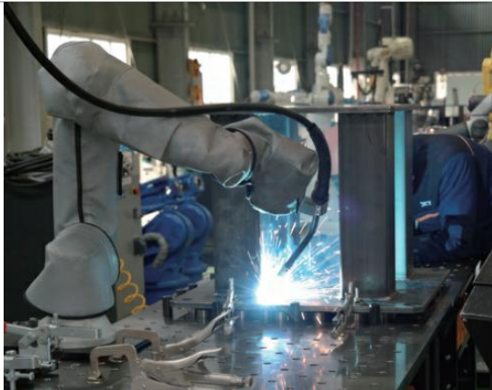
도표 237. 용접 현장에 활용되는 협동 로봇
