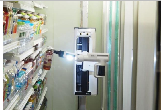
도표 364. 음료수 보충 작업을 수행하는 TX-SCARA
