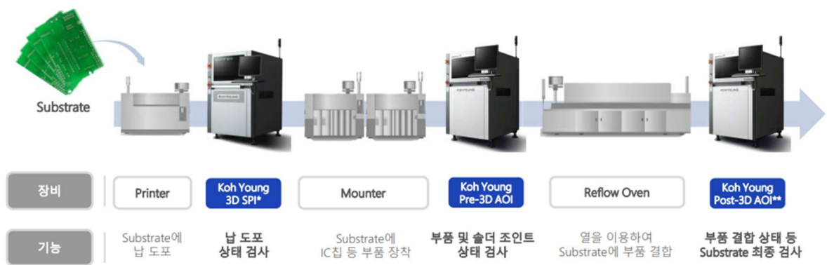
도표 8. 사업 영역: 전자제품 조립 공정에 투입되는 고영의 주요 장비
